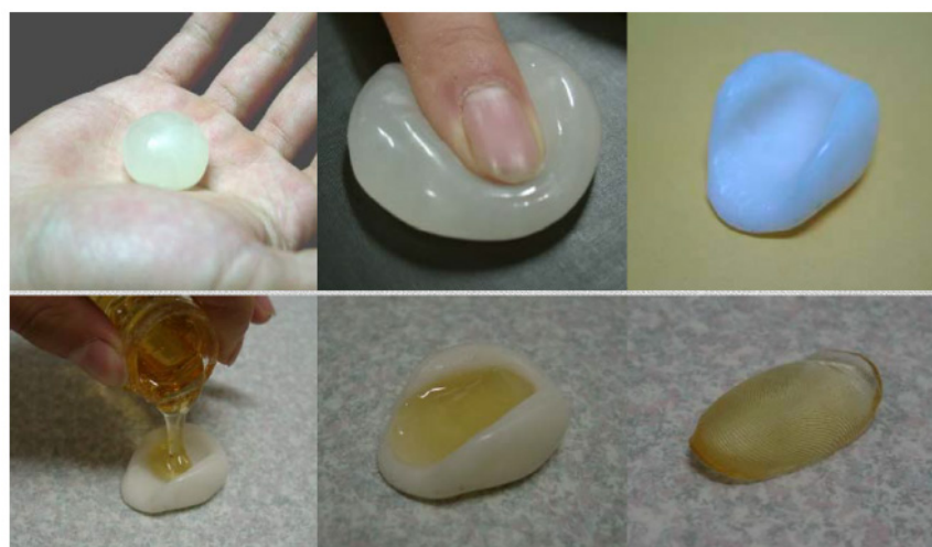
Figure 5 : Les étapes pour la création d'une fausse empreinte digitale par la méthode coopérative (extrait de [3]).
